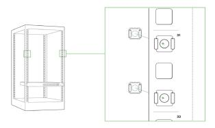
2. Прикрепите переднюю панель коммутатора к закладным гайкам на стойке.
